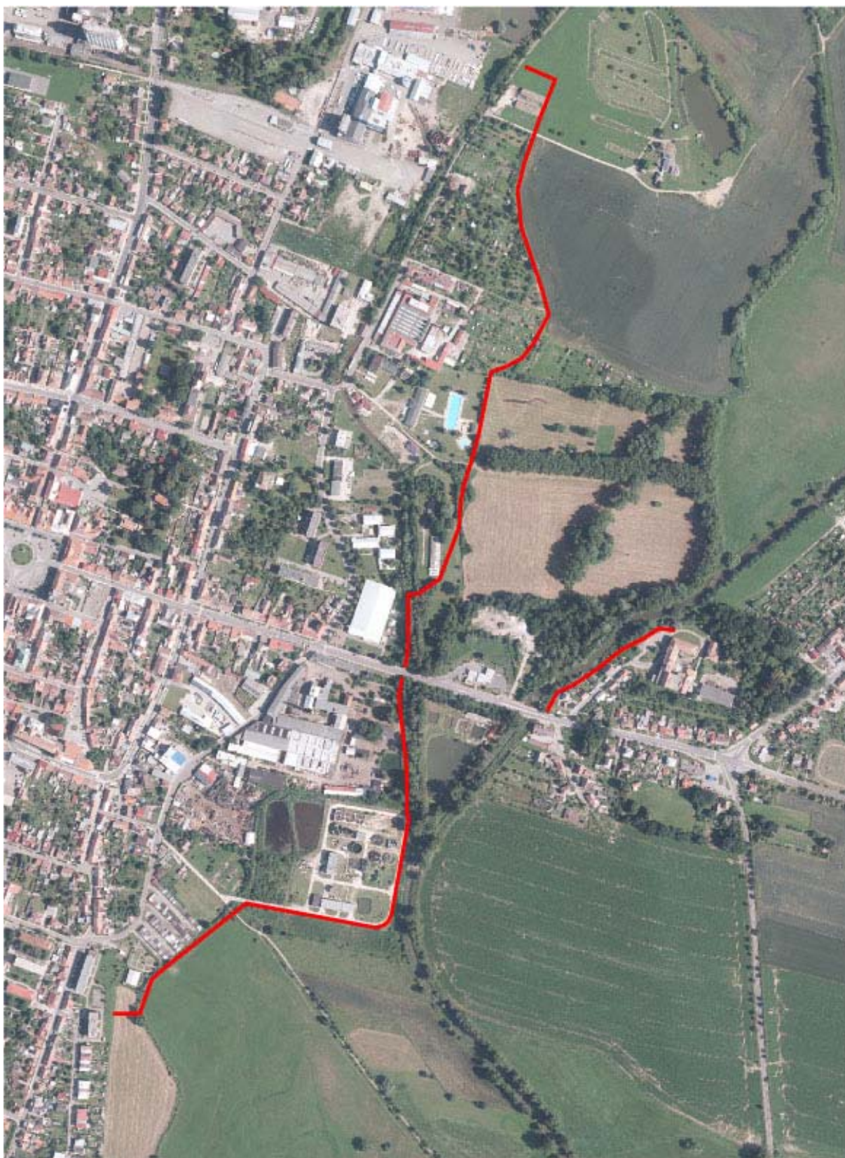
Obr. 3.2 – Návrh vedení linií protipovodňové ochrany – Varianta 1
