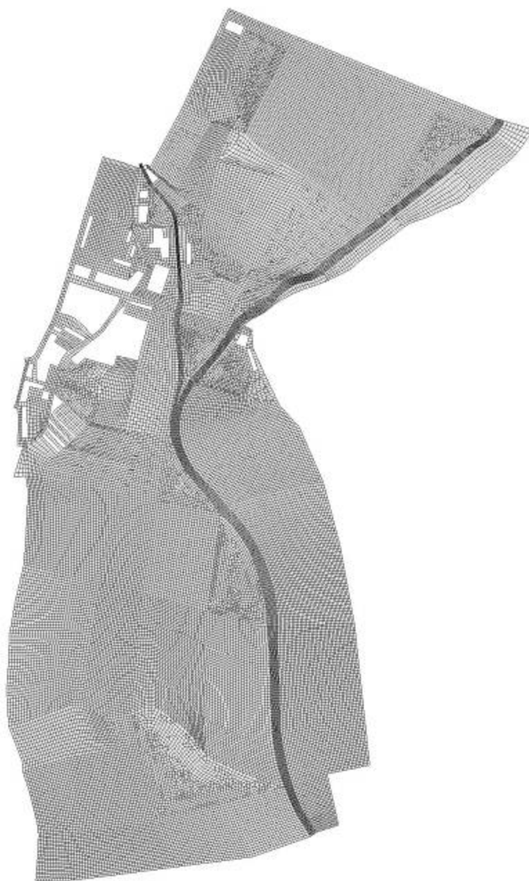
Obr. 5.1 – Rozsah výpočetní sítě modelu záplavového území Cidliny v Novém Bydžově
