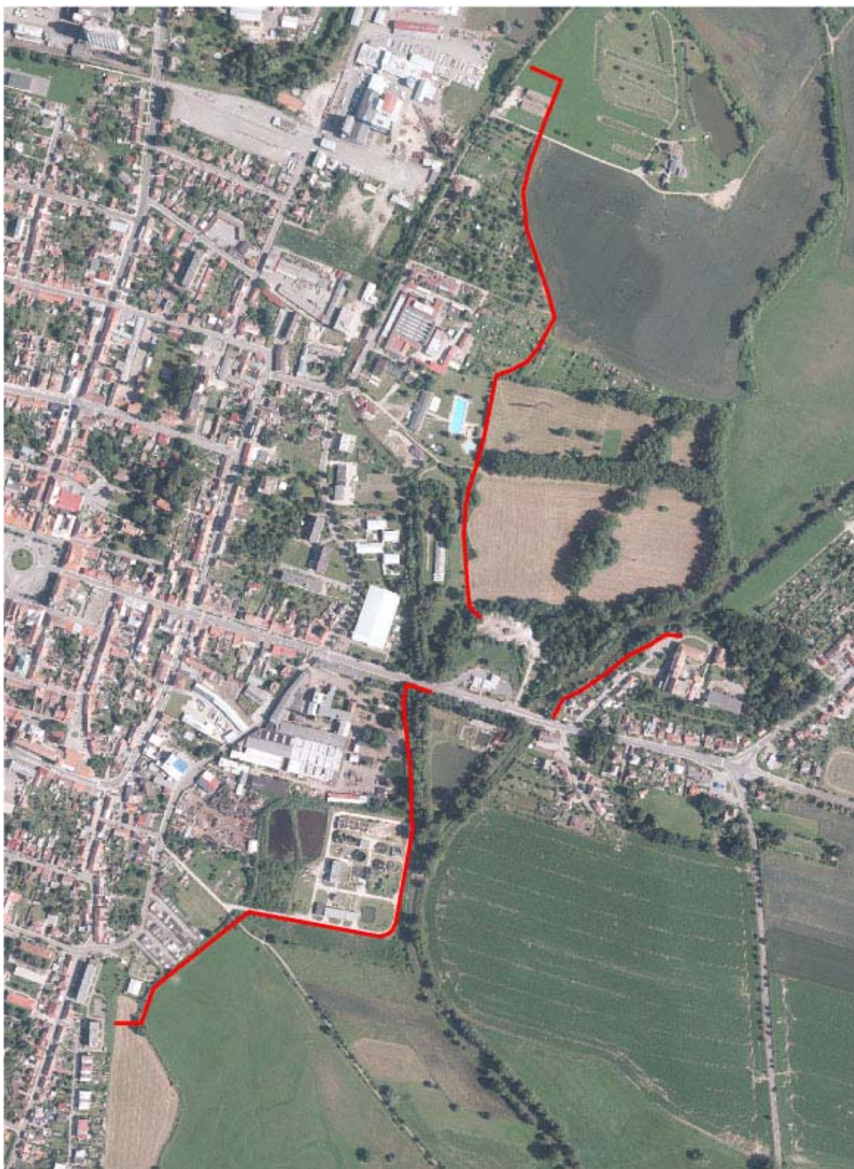
Obr. 3.3 – Návrh vedení linií protipovodňové ochrany – Varianta 2
