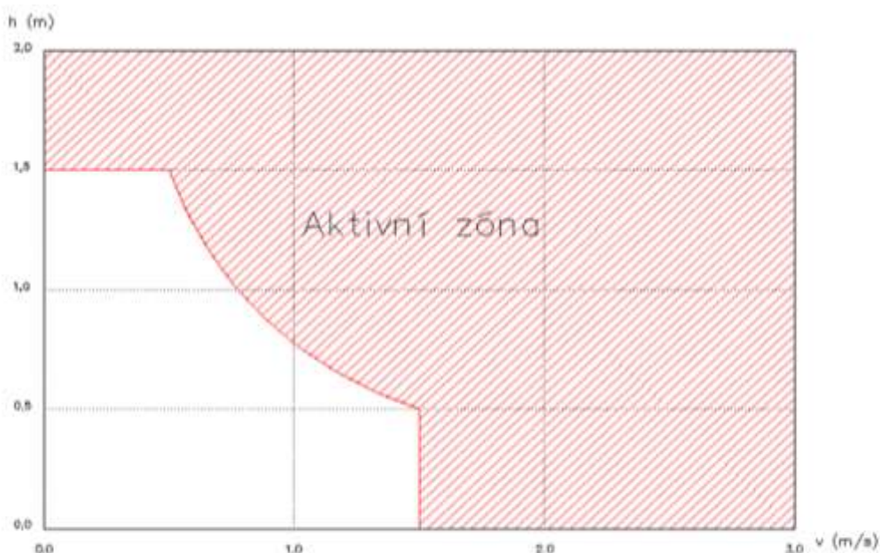
Obr. 1 Stanovení aktivní zóny záplavového území v závislosti na hloubce a rychlosti proudění podle Finka a Bewicka.
